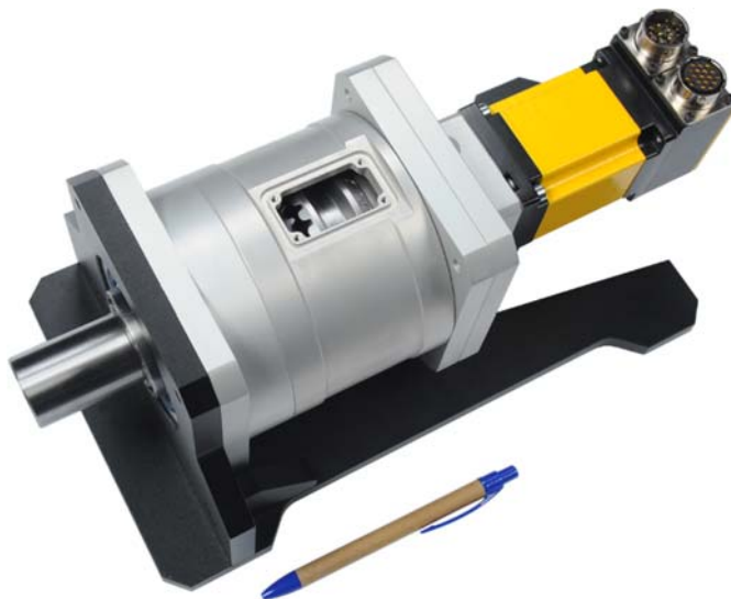
Fig. 9.29. Mostră experimentală ale servo-motoreductoarelor precesionale de mică putere ( d_m=80\text{ mm} ) cu angrenări A_{CX-CV}^{D,\beta} convex-concave cu dinți curbilinii (în arc de cerc) și roată-satelit montată axial flotant pe arborele-manivelă cu axe concurente în centrul de precesie ( i=-164 ) (a) și cu roți centrale interschimbabile cu locul cu rapoarte de transmitere i=-124/i=+125 (b).
