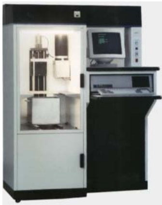
Fig. 1.47. Primul procedeu de imprimare 3D numit stereolitografie (SLA).
